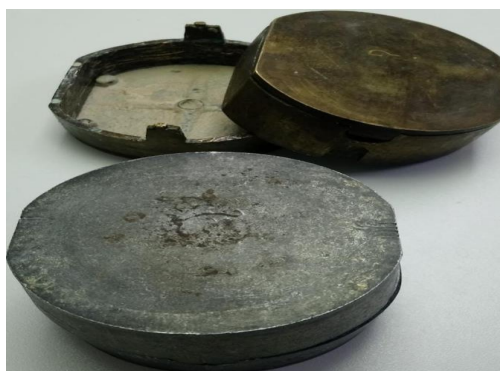
Рисунок 45. Общий вид, пресс-форма увеличенного размера для изготовления биоинженерной конструкции нижней челюсти.
