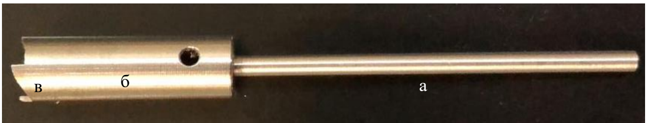
Рисунок 34 б. Общий вид изготовленной фрезы: а – хвостовик; б – рабочая часть; в – режущая кромка резцов
