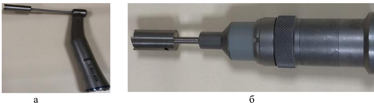
Рисунок 35. Фиксация фрезы: а – фреза фиксирована в угловом; б – прямом наконечнике
