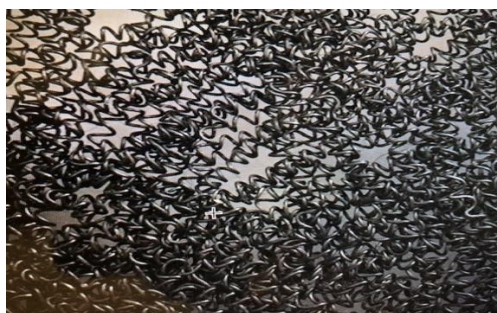
Рисунок 33. Титановая стружка для изготовления нетканого титанового материала со сквозной пористостью
