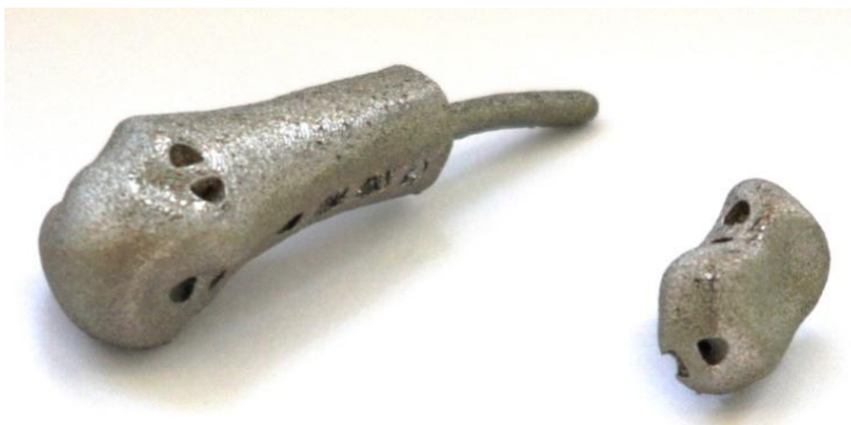
Рисунок 4. Компоненты эндопротеза II пястно-фалангового сустава, изготовленные с помощью цифрового прототипирования по оптимальным параметрам технологического процесса.
