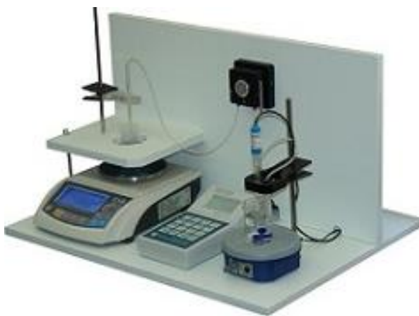
Рис.39. Установка для титрования (автоматическая) «Титрион-рН»
