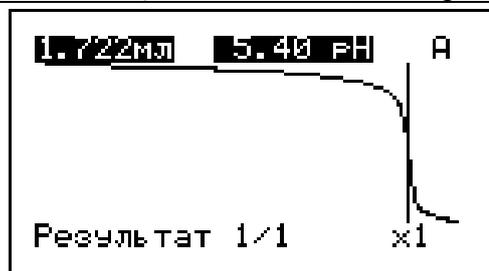
Рис. 8. Кривая титрования *Состав № 1* (интерфейс прибора)
