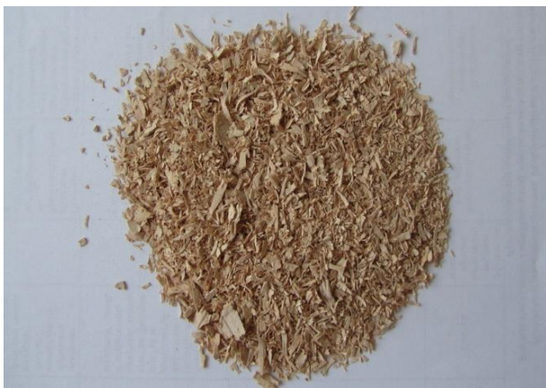
Рисунок 2.1. Образец бересты, измельченный классическим методом
