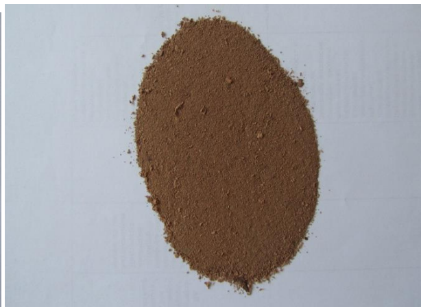
Рисунок 2.2. Образец бересты, измельченный методом механохимической активации
