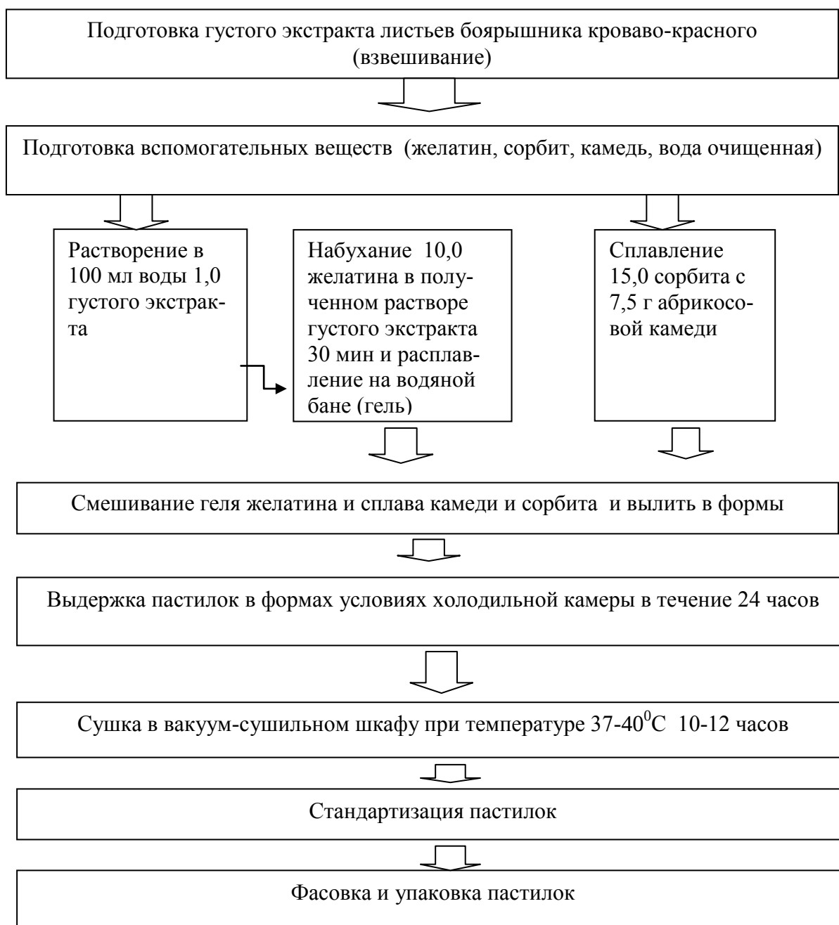
Рисунок 7.3.3. Схема получения сублингвальных пастилок
