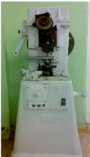
Рисунок 7 – Напольная кривошипная таблеточная машина салазочного типа.
